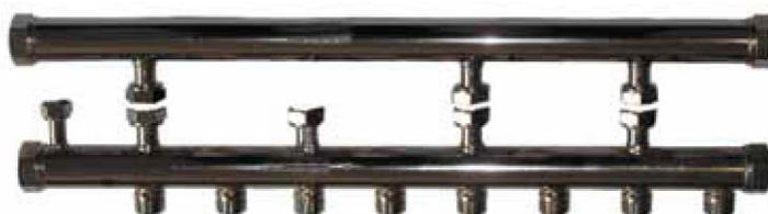
Collettori realizzati in rame nichelato con alimentazione da entrambi i lati diametro 1" e uscite diametro  $\frac{3}{4}$  maschio, la versione fornita sfusa riporta le stesse misure della serie assemblata.
