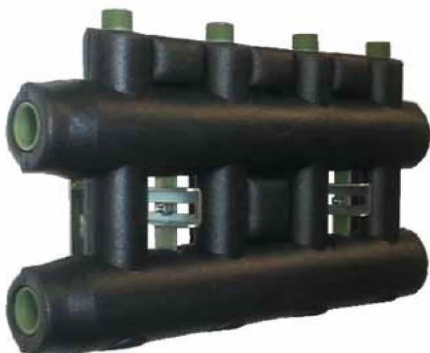
Realizzata in PPE termoformato a due densità, internamente Kg/m<sup>3</sup> 30 mentre l'esterno è di Kg/m<sup>3</sup>84 ,per rendere più resistente la coibentazione. Entrambi i materiali sono autoestinguenti in classe 1 .
