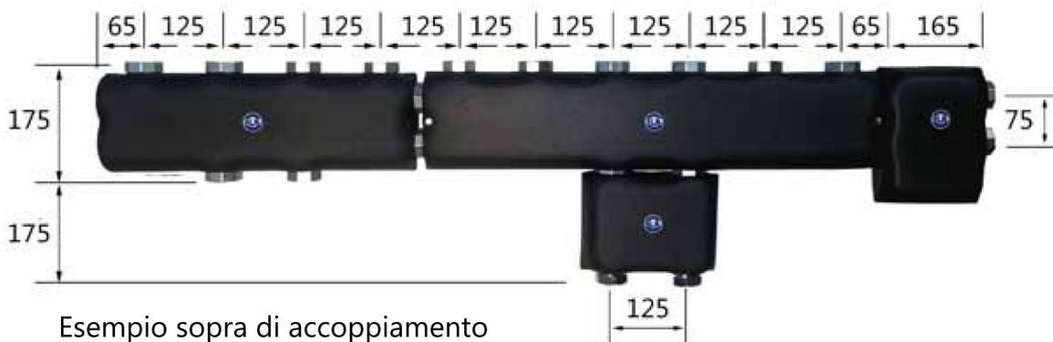
Esempio sopra di accoppiamento di un 2 zone più un 3 zone, con collegamento del separatore laterale codice SERIDN3275 ( può essere applicato lato DX o SX ) oppure si può applicare la versione orizzontale codice SERIDN40125.
