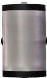
Accumulo termico (detto anche puffer o volano termico) realizzato in acciaio al carbonio, con supporti per fissaggio a parete e n° 2 attacchi del diametro 1" che lavorano sul ritorno dell'impianto, e altri n° 2 attacchi diametro 1" utilizzabili per sfiato e scarico.
